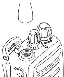
Assurez-vous que la radio est éteinte, placez l'antenne dans son orifice et vissez-la dans le sens horaire.
