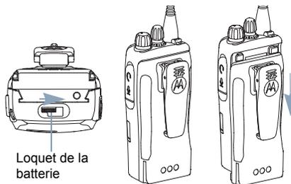
*Pour retirer la batterie, éteignez votre radio. Déverrouillez le loquet de la batterie et maintenez-le. Faites glisser la batterie vers le bas et soulevez-la des rainures.*
