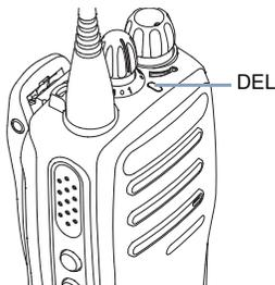
**Jaune continu** – La radio surveille un canal classique. Indique également un niveau de charge de batterie moyen lorsque la touche **Charge de la batterie** est enfoncée.
