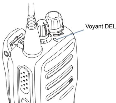
Le voyant DEL passe au vert continu lorsque la radio est en cours de transmission et clignote lorsque la radio est en cours de réception.
